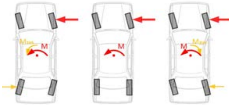
Abbildung 3: Radeinschlag bei der Hinterradlenkung bei pos. Vorderradlenkwinkel [2]
