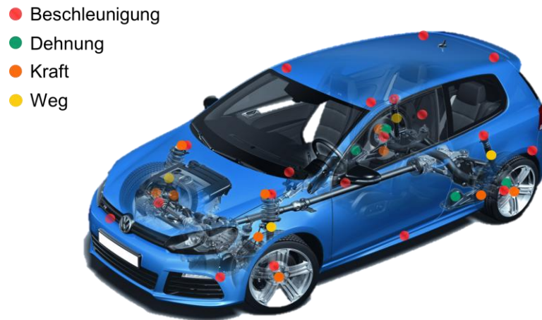
Abbildung 5: Sensoranordnung für Fahrbetriebsmessungen
